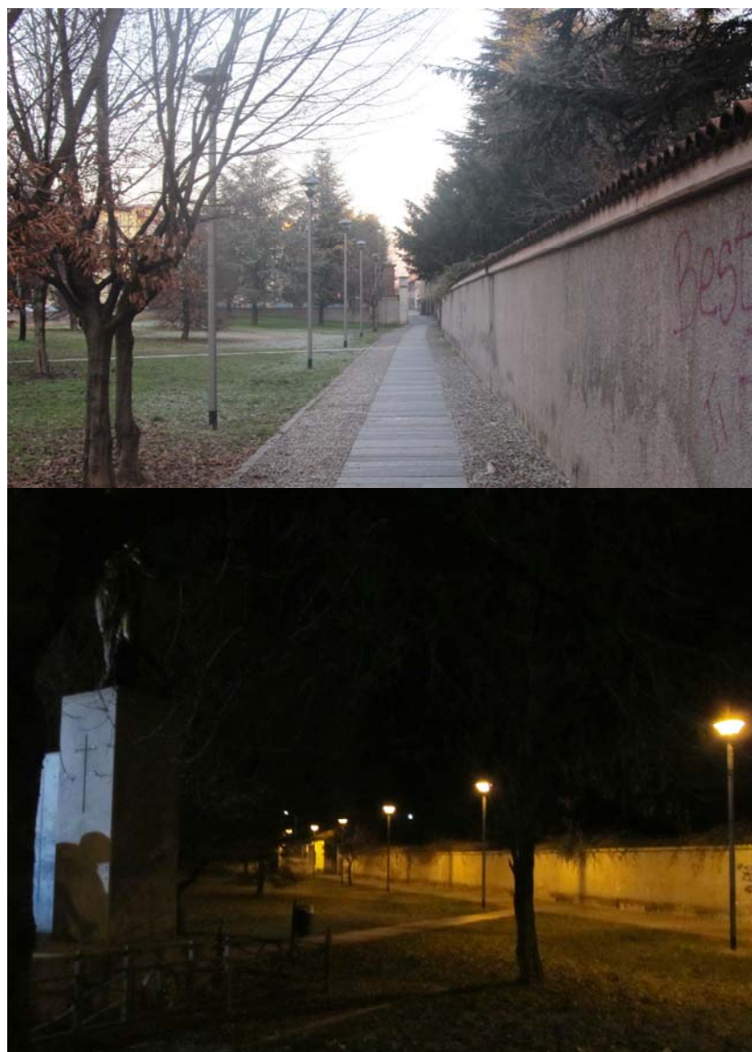
Area verde di Via della Repubblica: apparecchi di arredo urbano schermati conformi alla normativa vigente. Risulta evidente dalla percezione fotografica notturna il contenimento del flusso luminoso che non viene disperso verso la volta celeste.
